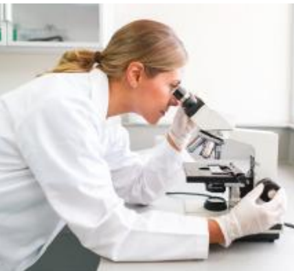
Comune microscopio ottico, in cui si riconoscono gli oculari, le viti macro e micrometriche, gli obiettivi e il vetrino con il preparato da esaminare.
